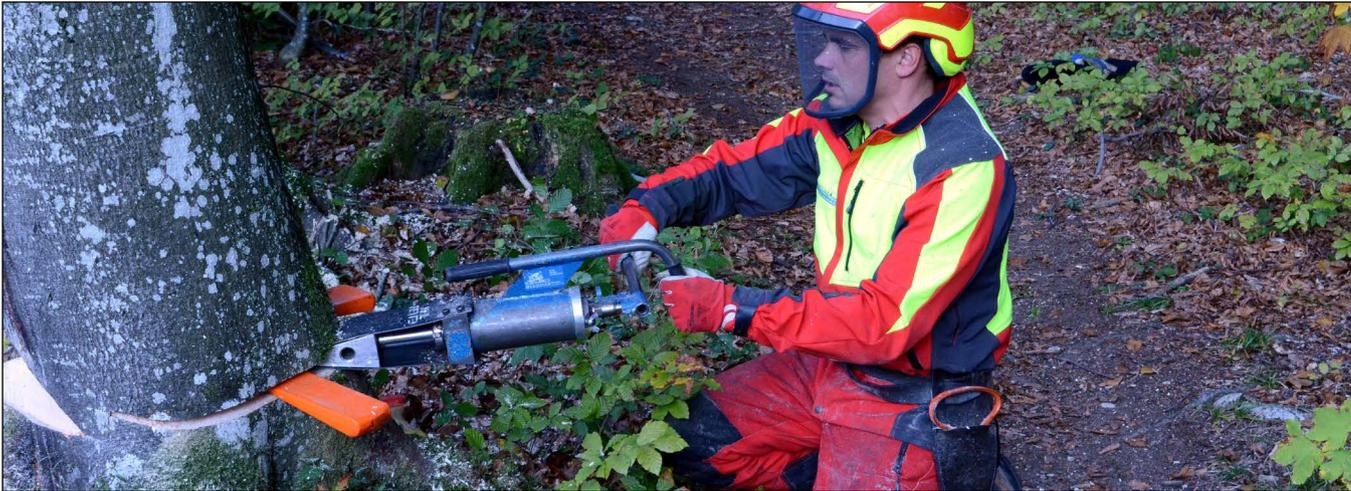
Ein **Zuggerät** ist ein Gerät, mit dem der Baumstamm in eine Richtung gezogen werden kann.
