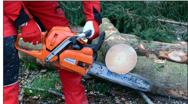
Stützen Sie die Motorsäge am Baumstamm ab und den hinteren Teil der Motorsäge am eigenen Körper. So können Sie das Gewicht und den Druck der Motorsäge ausgleichen.
