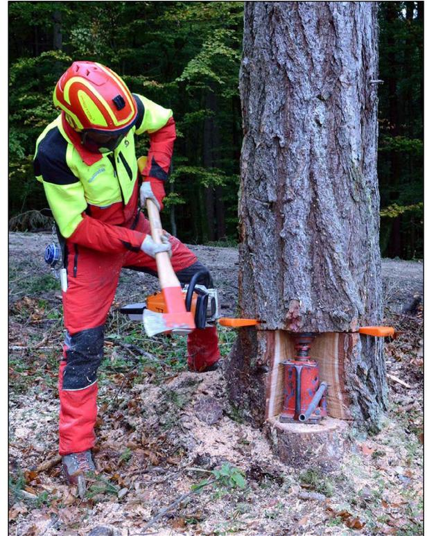
Der **hydraulische Fällkeil** ist auch eine Hilfe beim Fällen.
