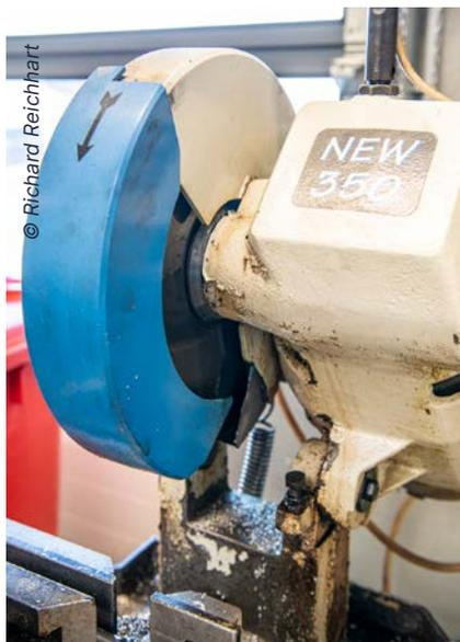
Schleifscheibe mit funktionsfähiger Schutzeinrichtung
