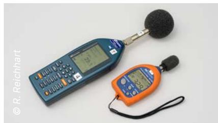
Schallpegelmessgeräte unterschiedlicher Ausführung
