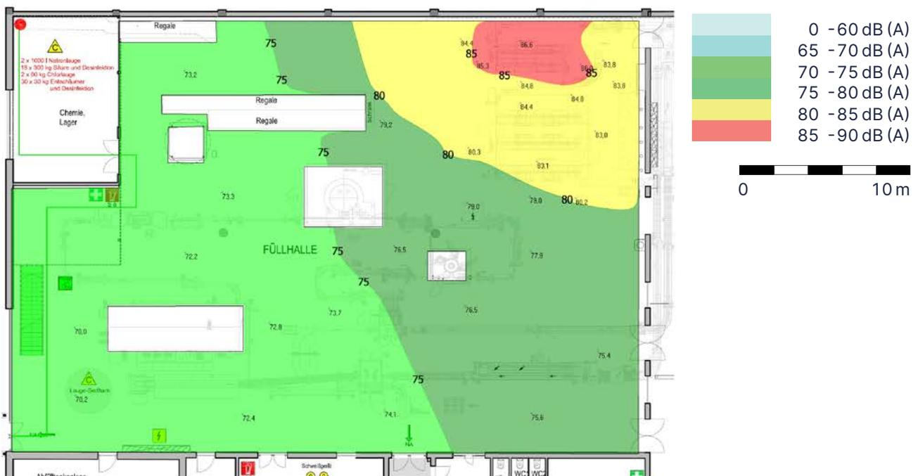
Abb. 13: Schalldruckpegel in einer Halle vor Ergreifen von Maßnahmen
