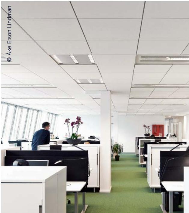
**Abb. 8:** Abgehängte Rasterdecken mit schallabsorbierenden Platten sind eine gute Wahl für alle Arbeitsräume.
