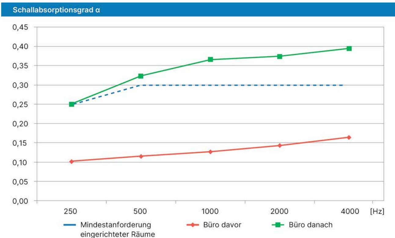
Abb. 12: Entwicklung des Schallabsorptionsgrads vor einer Maßnahme und nach Montage von 8 Deckensegeln und 7 m<sup>2</sup> Absorbieren an den Wänden.
