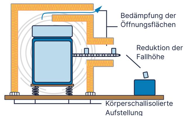
Abb. 7: Aufbau einer Kapselung mit Öffnungen
