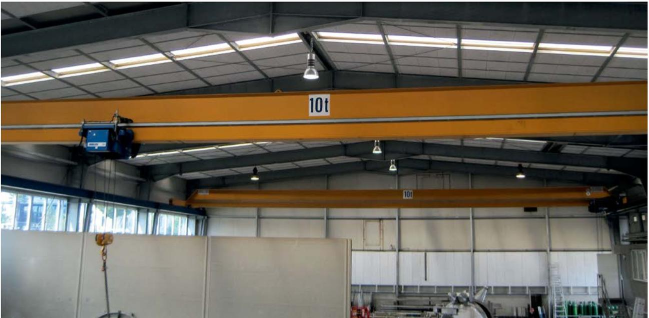
Abb. 15: Umsetzung von Schallschirmen in einer Halle. Wichtig ist, dass eine schallabsorbierende Decke vorhanden ist und auch der Schallschirm mit schallschluckendem Material ausgestattet wird.
