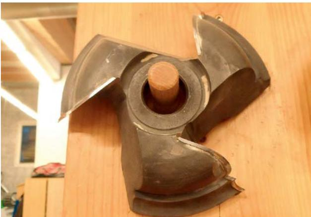
**Abb. 18:** Altes Fräswerkzeug (für Holzbearbeitung nicht mehr zulässig)
