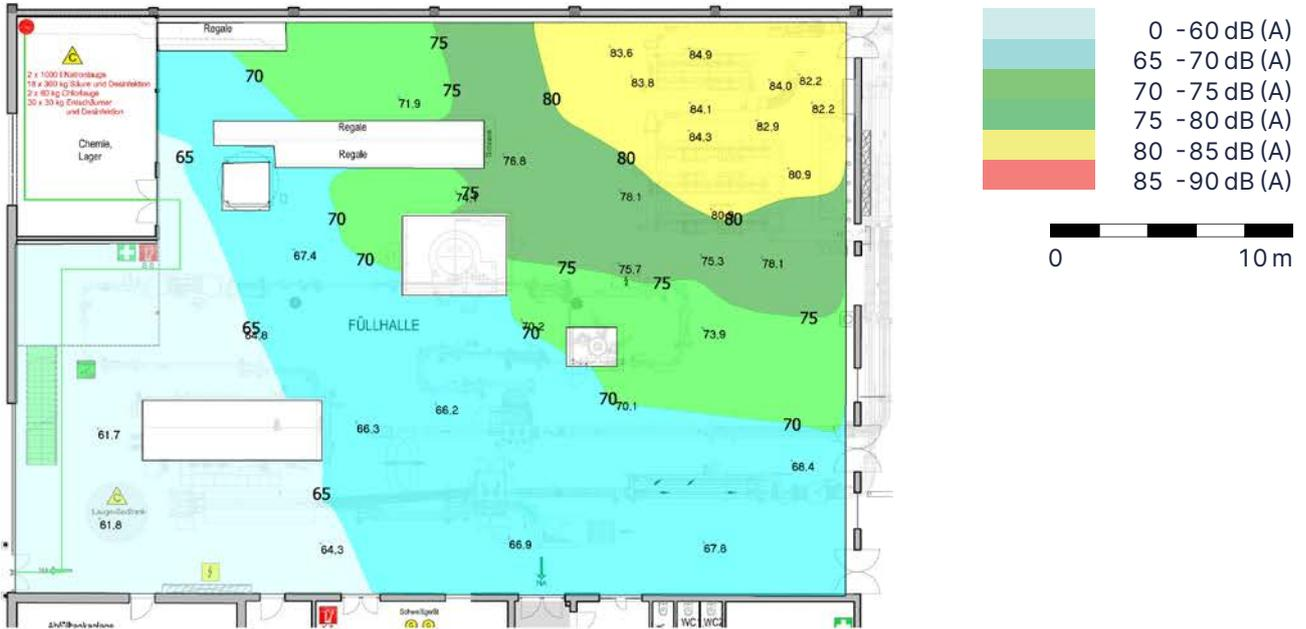
Abb. 14: Schalldruckpegel in einer Halle nach Ergreifen von Maßnahmen
