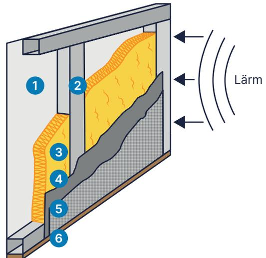
Abb. 6: Aufbau einer Kapselwand oder einer Schallschutzwand
